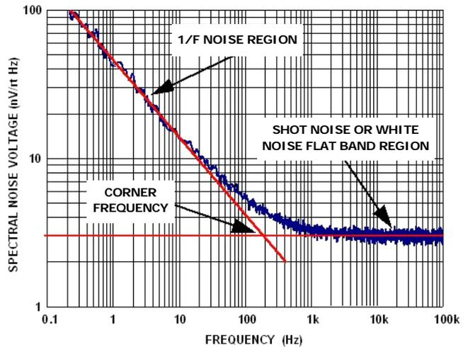
FIGURE 1. AMPLIFIER INTERNAL VOLTAGE NOISE (RTI) vs FREQUENCY
